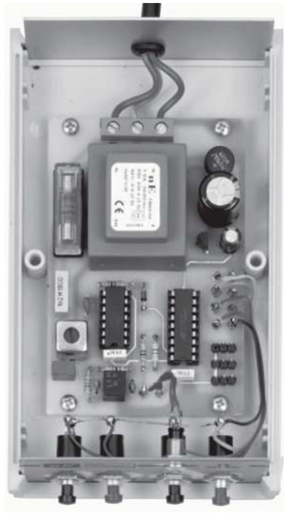
Fig.11 Fotografía del circuito impreso del Transmisor una vez instalado dentro del mueble de plástico que proporcionamos perforado y serigrafiado. Se pueden observar claramente las conexiones de los 4 pulsadores y del cable de red. A la izquierda se encuentran el transformador y el portafusibles, con su correspondiente fusible ya instalado.
