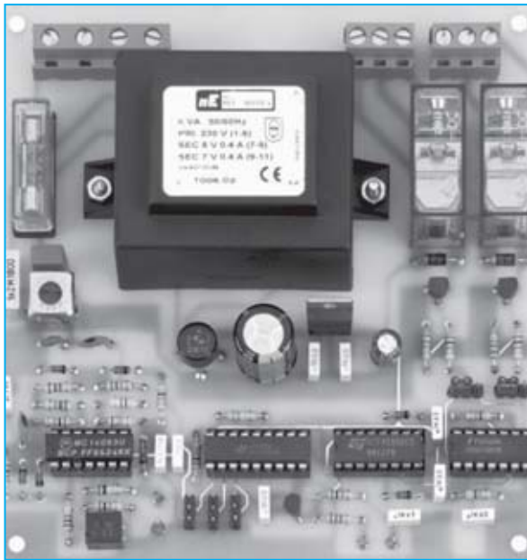
Fig.13 Fotografía del circuito impreso del Receptor LX.1654 con todos sus componentes montados. A los lados del transformador se encuentran el portafusibles, con su correspondiente fusible, y los dos relés que controlan la carga.
